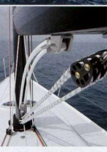
Sopra, il sistema del wang a paranco, fornito di aste flessibili. A sinistra, il passavanti libero da ingombri e la tuga, molto pulita.
